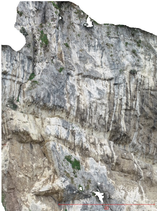
Figura 18 Marcata persistenza del sistema 2 nel settore orientale della parete
