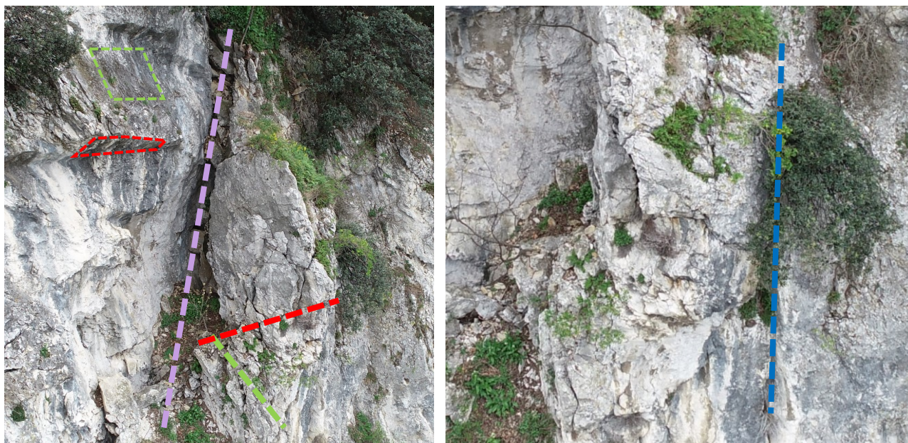
Figura 34 Pilastro in precario stato di stabilità
