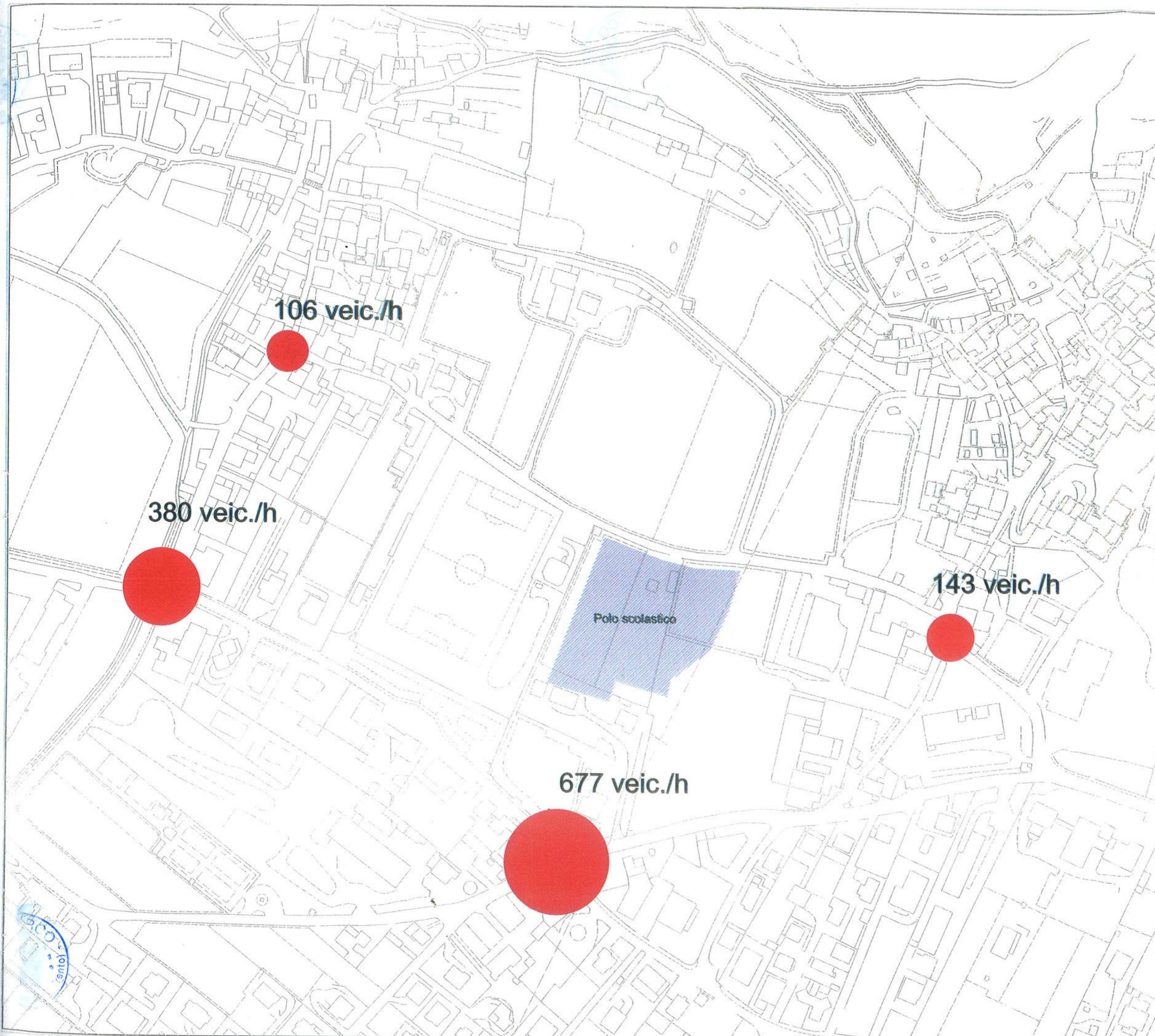
Flusso veicolare omogeneizzato in confluenza agli incroci di rilievo - giugno 2001 - ore 7.30-8.30-
