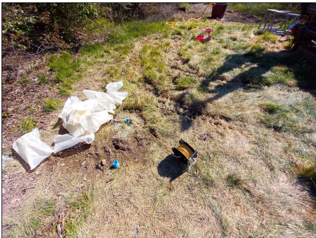
Fig. 14: misura falda con freatimetro
