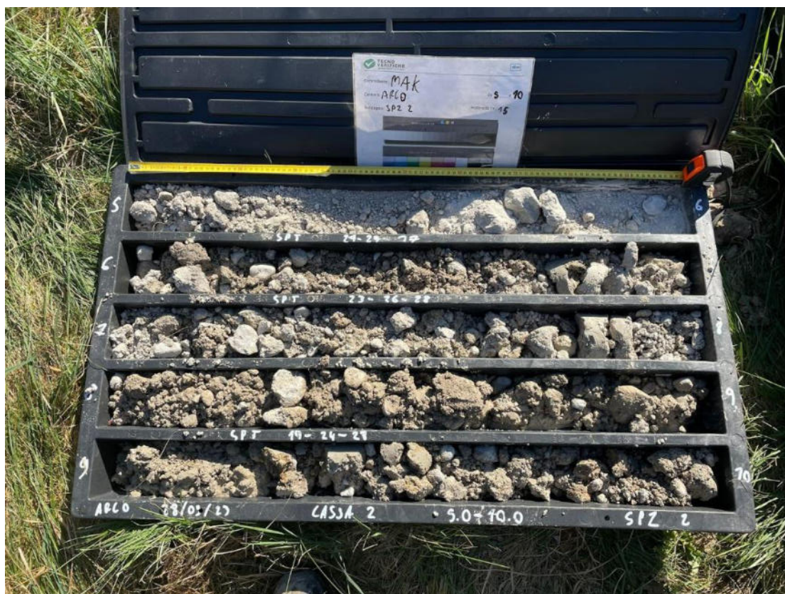
Fig 8: Cassetta catalogatrice da 5 a 10 m del sondaggio S2
