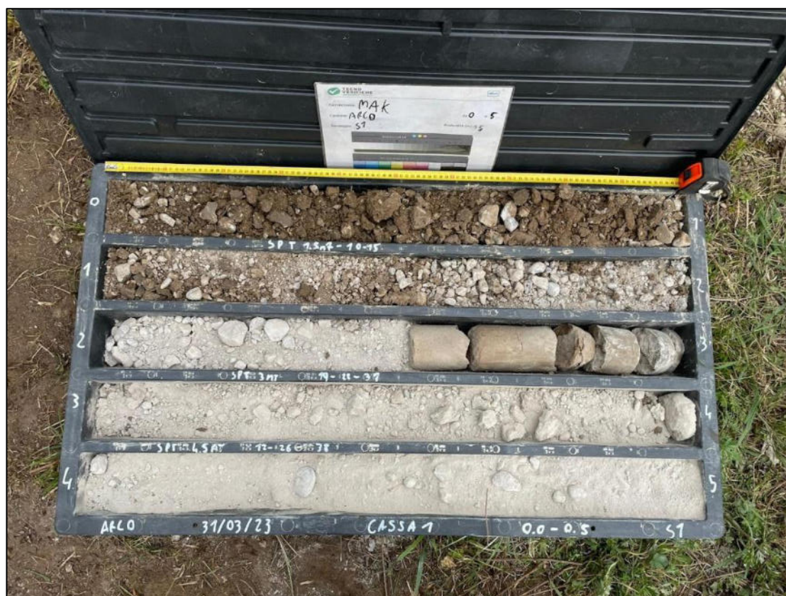
Fig 3: Cassetta catalogatrice da 0 a 5 m del sondaggio S1
