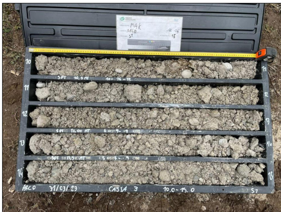
Fig 5: Cassetta catalogatrice da 10 a 15 m del sondaggio S1
