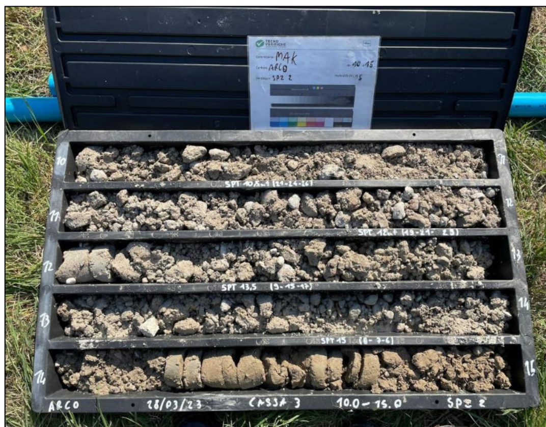
Fig 9: Cassetta catalogatrice da 10 a 15 m del sondaggio S2
