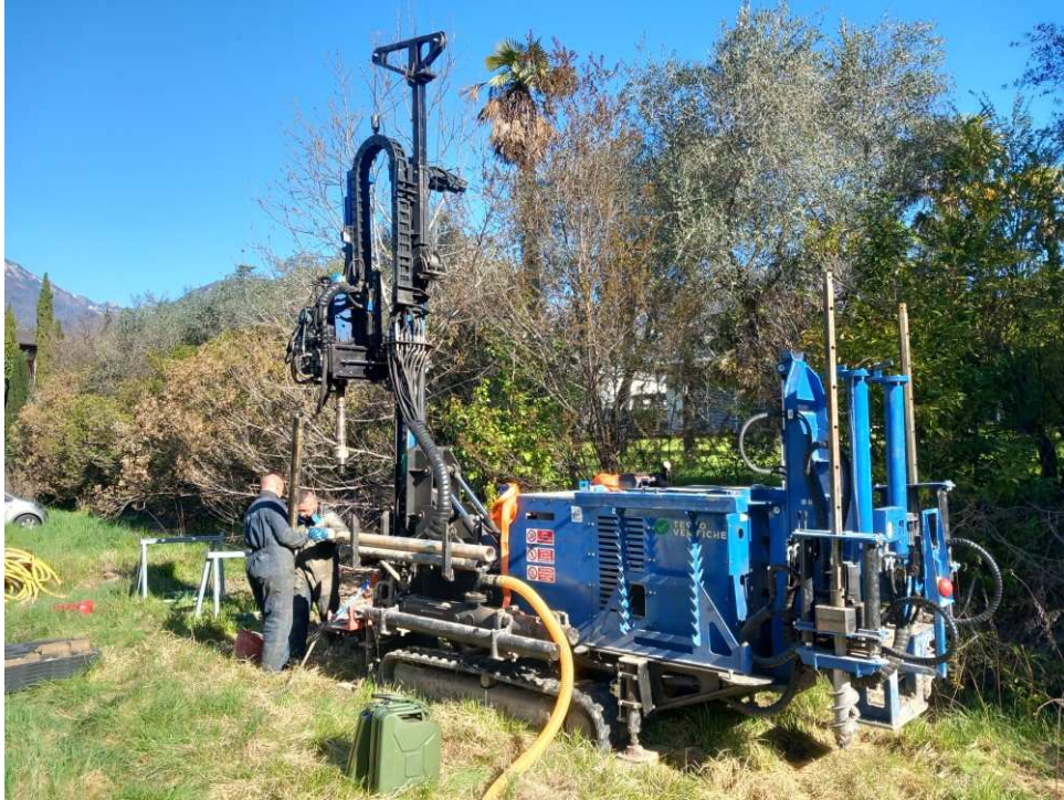
Fig. 13: carotiere sul punto di sondaggio S2
