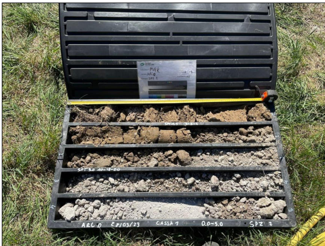
Fig 7: Cassetta catalogatrice da 0 a 5 m del sondaggio S2
