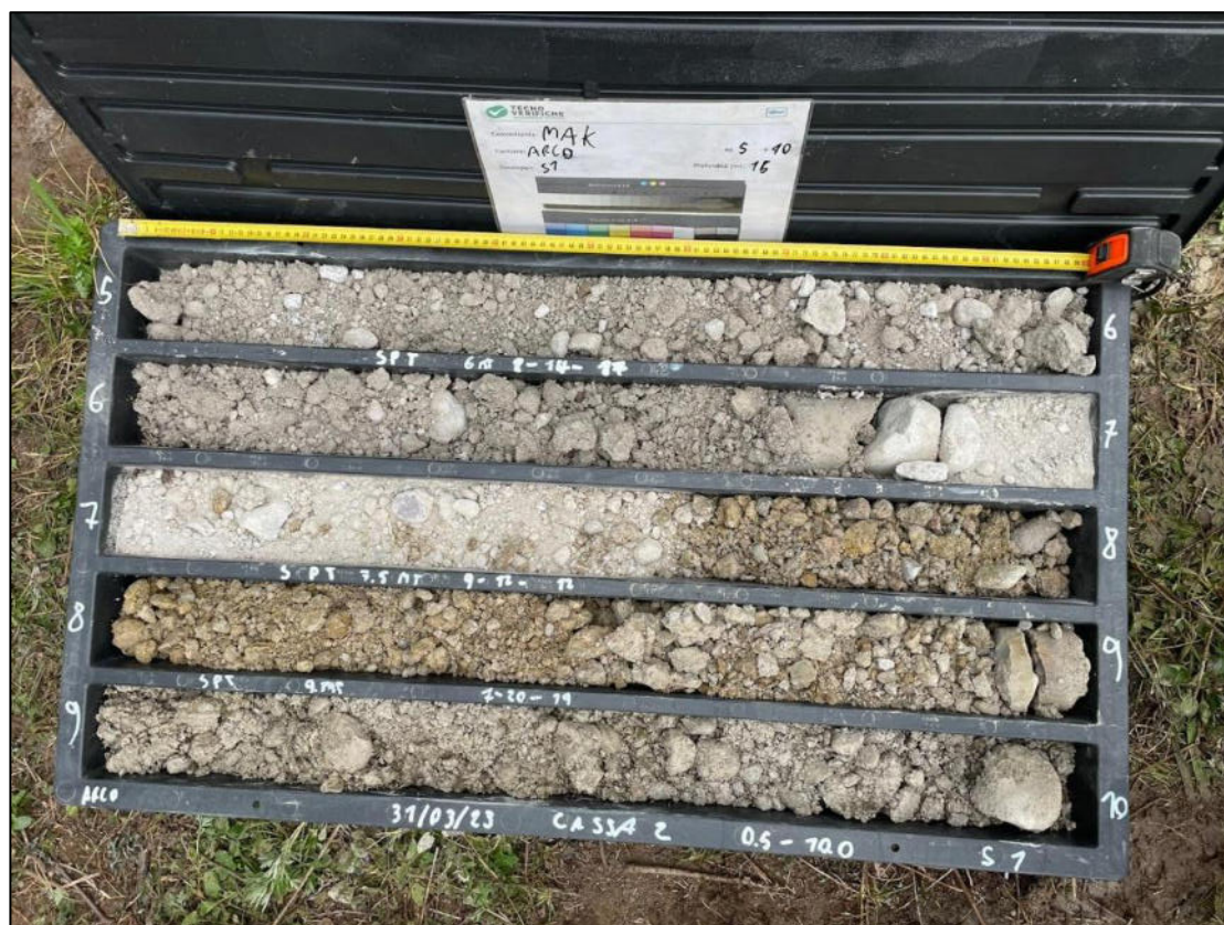
Fig 4: Cassetta catalogatrice da 5 a 10 m del sondaggio S1
