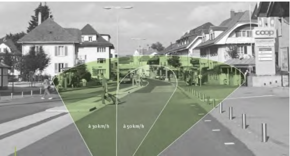
Apertura del cono visivo viaggiando a 30 km/h o a 50 km/h
