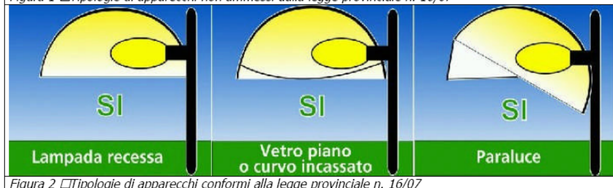
Figura 2 □ Tipologie di apparecchi conformi alla legge provinciale n. 16/07
